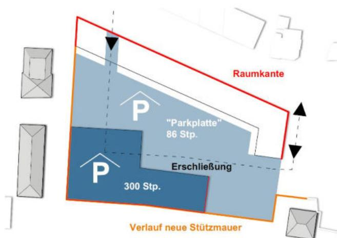
Abbildung 105: Systemskizze Entwurfsvariante Baufeld Mitte – Parkhaus mit Randbebauung und Parkplatte
