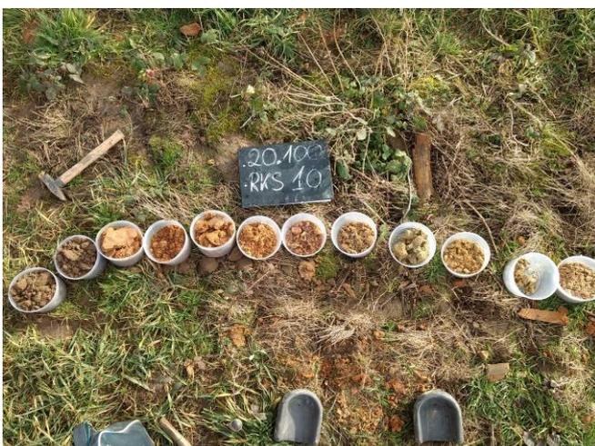
Bild 35: Lange Strahläcker, Neustadt/Weinstr., RKS 10, Detailaufnahme, Bohrgut in Probenbehältern
