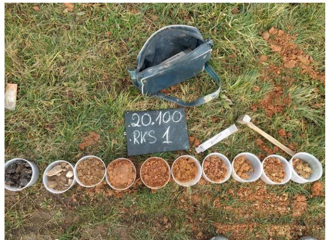
Bild 4: Lange Strahläcker, Neustadt/Weinstr., RKS 1, Detailaufnahme, Bohrgut in Probenbehältern
