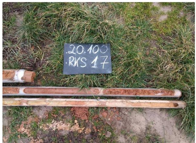
Bild 54: Lange Strahläcker, Neustadt/Weinstr., RKS 17, Detailaufnahme, Bohrgut in Bohrschappe Teil 2
