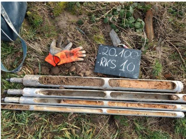
Bild 33: Lange Strahläcker, Neustadt/Weinstr., RKS 10, Detailaufnahme, Bohrgut in Bohrschappe Teil 1
