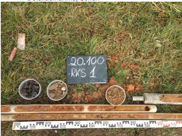
Bild 5: Lange Strahläcker, Neustadt/Weinstr., RKS 1, Detailaufnahme, Schurfgut in Bohrschappe Teil 1
