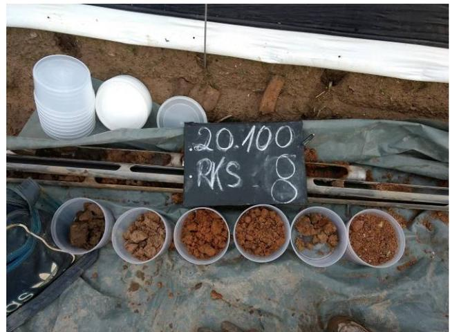
Bild 28: Lange Strahläcker, Neustadt/Weinstr., RKS 8, Detailaufnahme, Bohrgut in Probenbehältern
