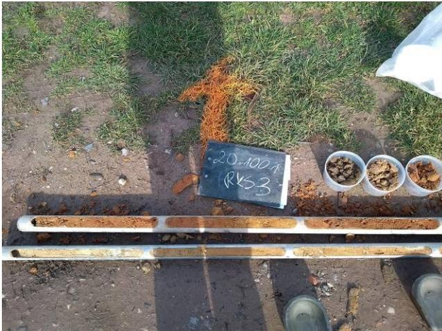
Bild 13: Lange Strahläcker, Neustadt/Weinstr., RKS 3, Detailaufnahme, Bohrgut in Bohrschappe Teil 1
