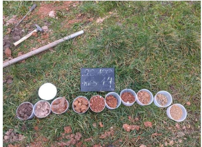
Bild 44: Lange Strahläcker, Neustadt/Weinstr., RKS 14, Detailaufnahme, Bohrgut in Probenbehältern
