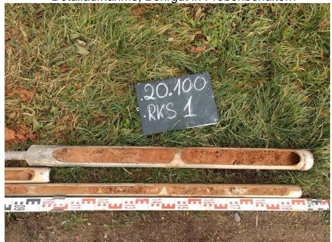
Bild 6: Lange Strahläcker, Neustadt/Weinstr., RKS 1, Detailaufnahme, Schurfgut in Bohrschappe Teil 2
