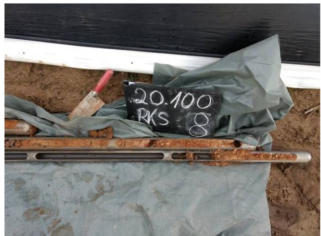
Bild 30: Lange Strahläcker, Neustadt/Weinstr., RKS 8, Detailaufnahme, Bohrgut in Bohrschappe Teil 2
