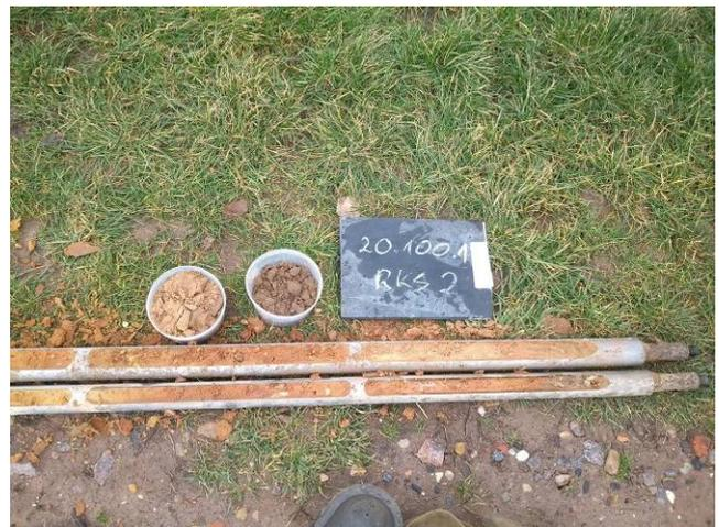
Bild 10: Lange Strahläcker, Neustadt/Weinstr., RKS 2, Detailaufnahme, Bohrgut in Bohrschappe Teil 2
