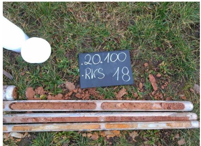
Bild 58: Lange Strahläcker, Neustadt/Weinstr., RKS 18, Detailaufnahme, Bohrgut in Bohrschappe Teil 2
