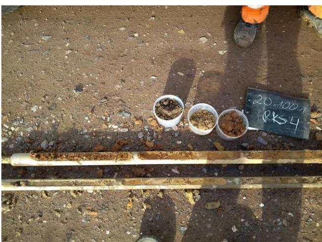
Bild 17: Lange Strahläcker, Neustadt/Weinstr., RKS 4, Detailaufnahme, Bohrgut in Bohrschappe Teil 1
