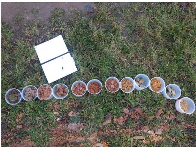
Bild 59: Lange Strahläcker, Neustadt/Weinstr., RKS 18, Detailaufnahme, Bohrgut in Probenbehältern
