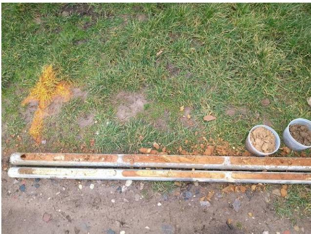
Bild 9: Lange Strahläcker, Neustadt/Weinstr., RKS 2, Detailaufnahme, Bohrgut in Bohrschappe Teil 1
