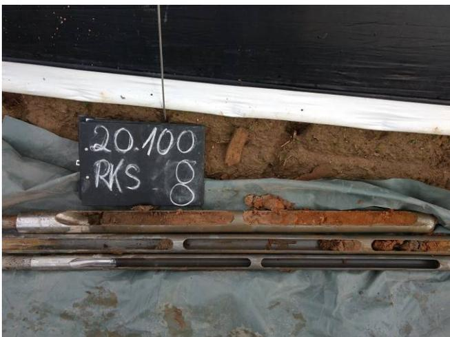
Bild 29: Lange Strahläcker, Neustadt/Weinstr., RKS 8, Detailaufnahme, Bohrgut in Bohrschappe Teil 1
