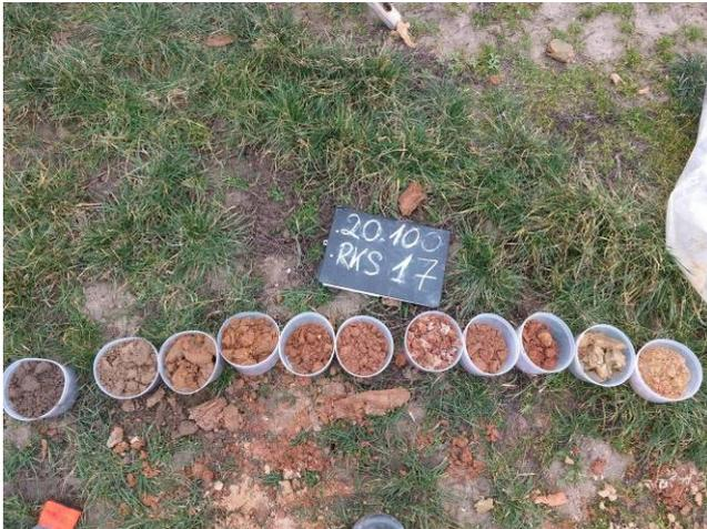
Bild 55: Lange Strahläcker, Neustadt/Weinstr., RKS 17, Detailaufnahme, Bohrgut in Probenbehältern
