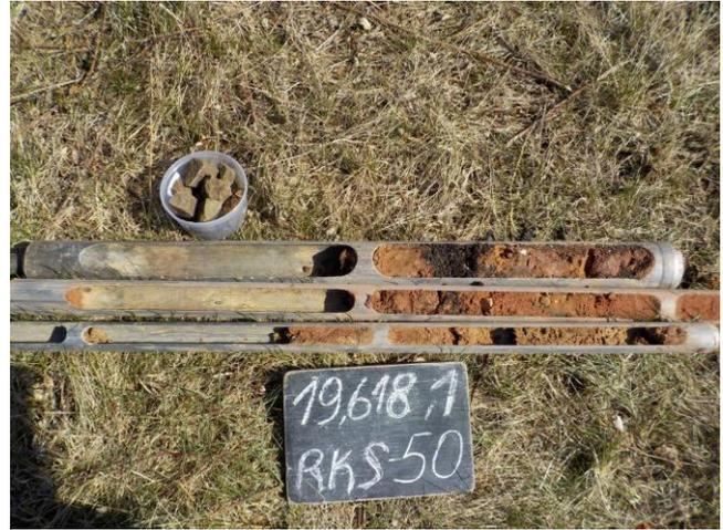
Bild 14: Bohrgut und Bohrschappen RKS 50
