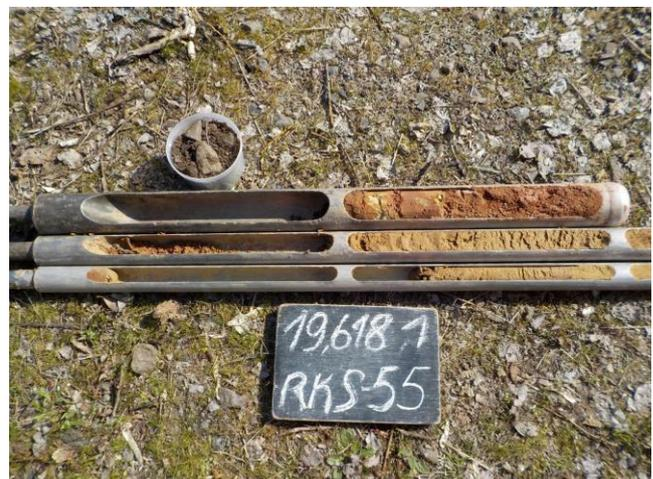
Bild 24: Bohrgut und Bohrschappen RKS 55
