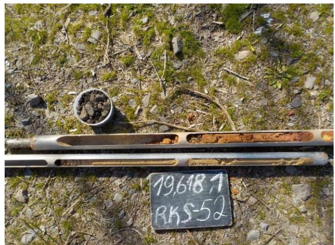
Bild 18: Bohrgut und Bohrschappen RKS 52
