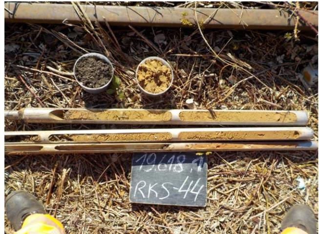
Bild 2: Bohrgut und Bohrschuppen RKS 44
