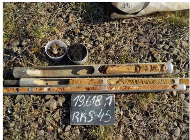
Bild 4: Bohrgut und Bohrschuppen RKS 45
