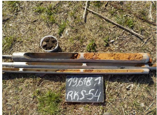
Bild 22: Bohrgut und Bohrschappen RKS 54
