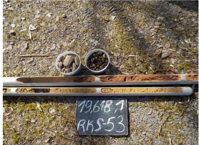
Bild 20: Bohrgut und Bohrschappen RKS 53
