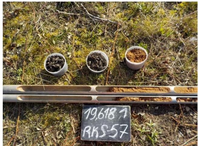
Bild 28: Bohrgut und Bohrschuppen RKS 57
