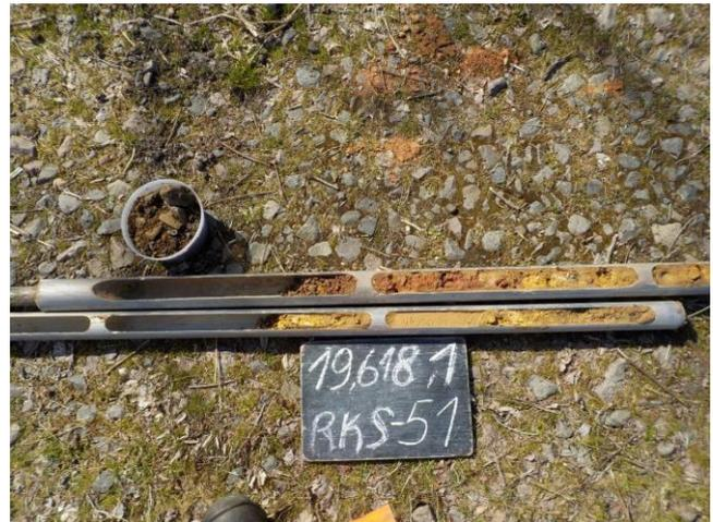
Bild 16: Bohrgut und Bohrschappen RKS 51
