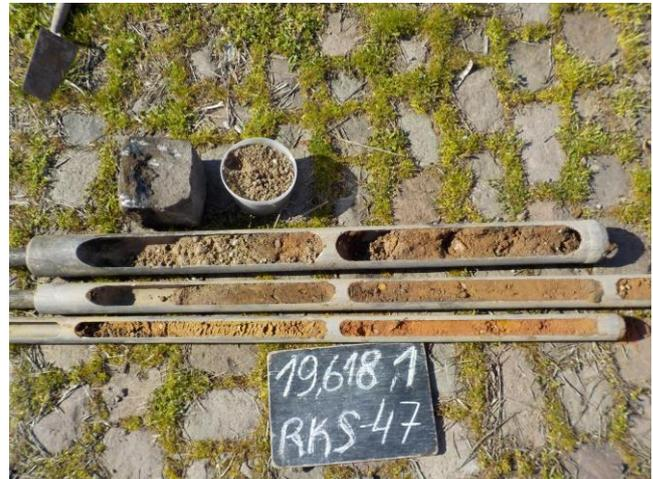
Bild 8: Bohrgut und Bohrschappen RKS 47
