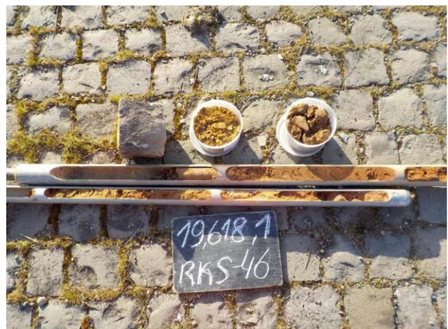
Bild 6: Bohrgut und Bohrschuppen RKS 46
