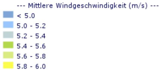
Insgesamt ist festzustellen, dass die Windhöffigkeit mit steigender Höhe zunimmt. Im Bereich der Mußbacher Fläche liegt sie in 100 m über Grund im Bereich zwischen 5,4 m/s und 5,6 m/s und in 160 m Höhe zwischen 5,6 m/s und 5,8 m/s.<sup>2</sup> In jedem Falle kann hier gemäß weiter vorne stehender Definition nicht von einem Standort mit hoher Windhöffigkeit ausgegangen werden.
