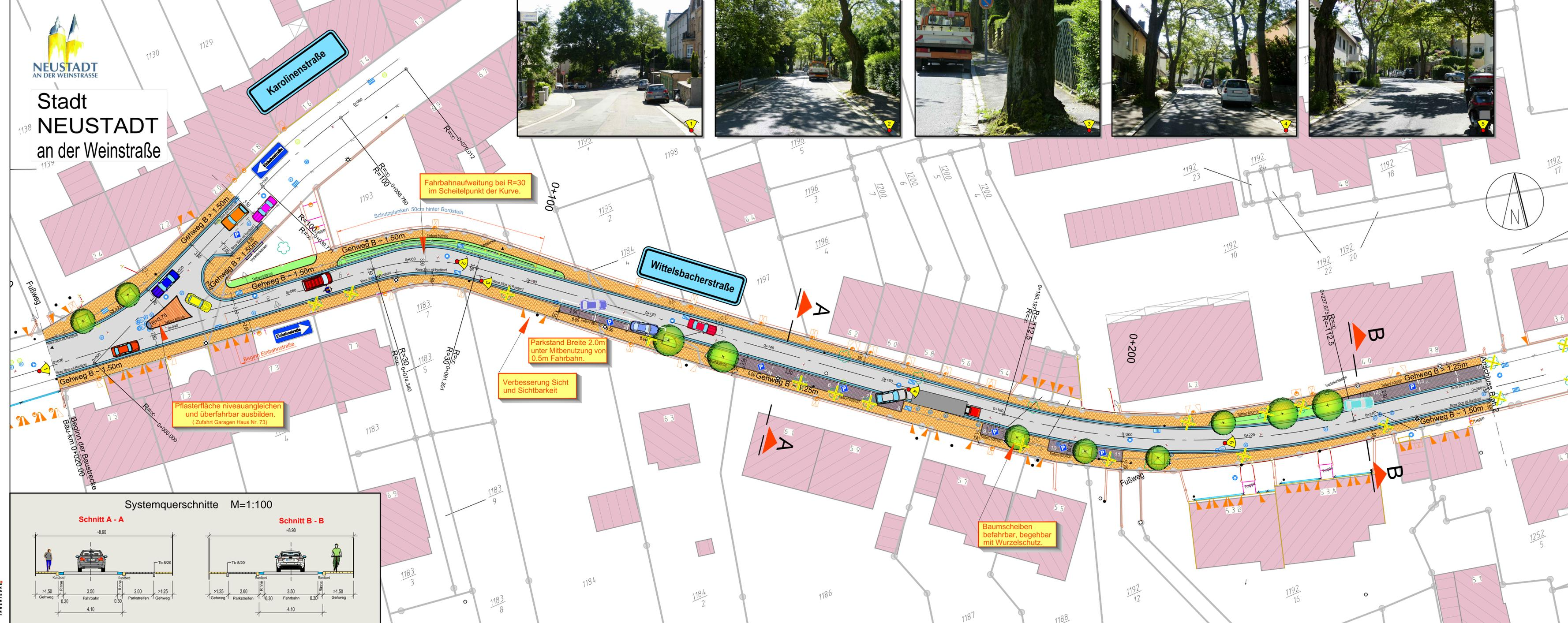
Fahrbahnaufweitung bei R=30 im Scheitelpunkt der Kurve.
