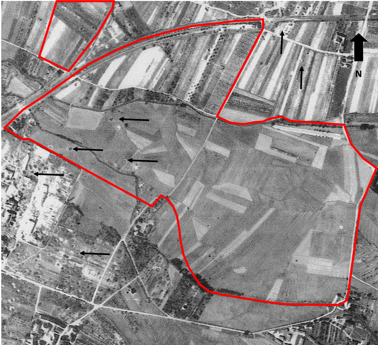
Abbildung 57: Luftbild ALK 598/Bild 3304 (28. August 1945) mit deutlich erkennbaren Bombentrümmern nördlich Abschnitt Ost, im Bereich Teilfläche I c und III a sowie starken Zerstörungen südlich III a (schwarze Pfeile) Das Plangebiet (rot markiert) weist noch keine Bebauung auf
