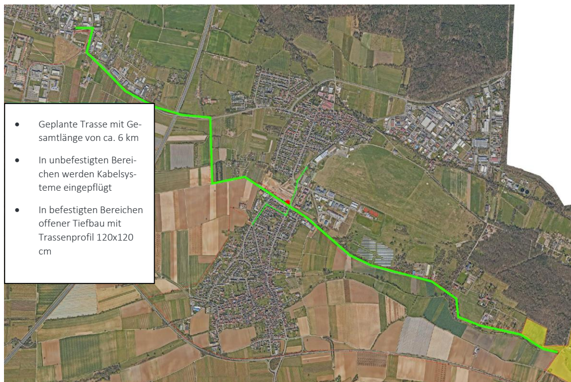
Abbildung 10: Geplanter Trassenverlauf zur Netzanbindung
