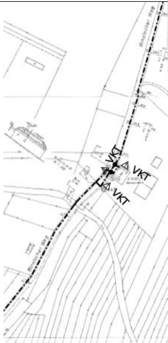
Abbildung 2: Leitungsverlauf Telekom westlich Teilfläche 7
